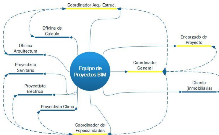
Figura 11. Actores que forman el equipo de proyectos BIM, junto con la manera de interactuar entre sí.
