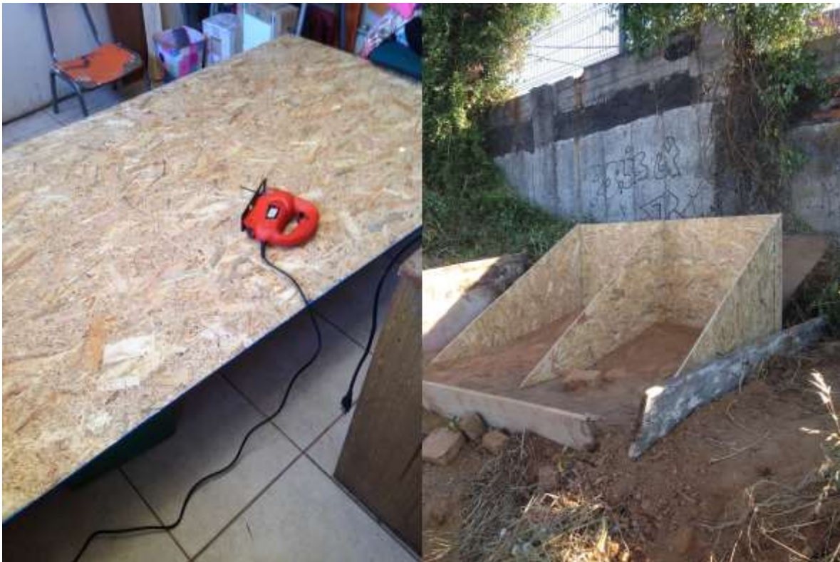
Confección y previa instalación de los lisímetros. Fuente: Elaboración propia (2017).
