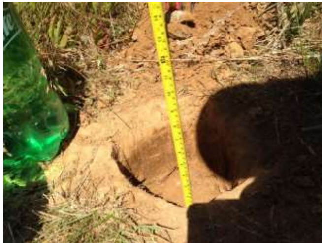
Perforación para ensayo Porchet, Fuente: Elaboración propia. (2017).
