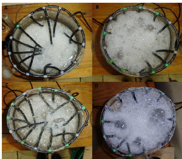
Figura 26. Espuma desarrollada en tanques a escala de laboratorio al final de la experiencia (día 42). (A) Reactor 1, (B) Reactor 2, (C) Reactor 3, (D) Reactor 4.
