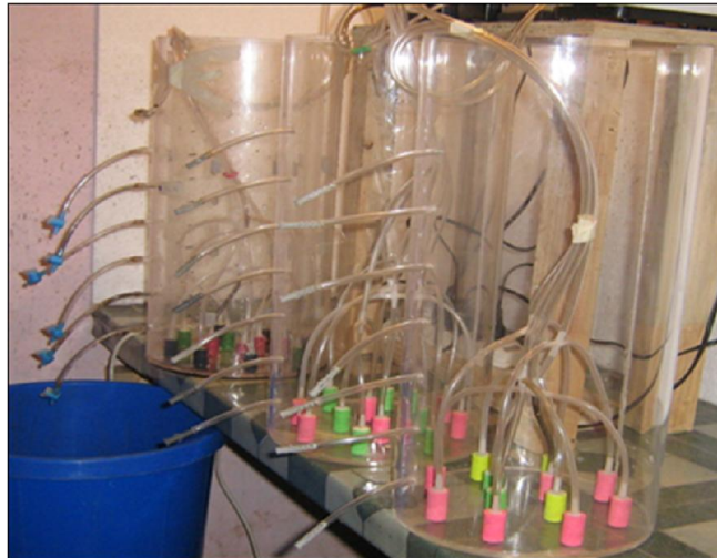
Figura 8. Reactor SBR a escala de laboratorio
