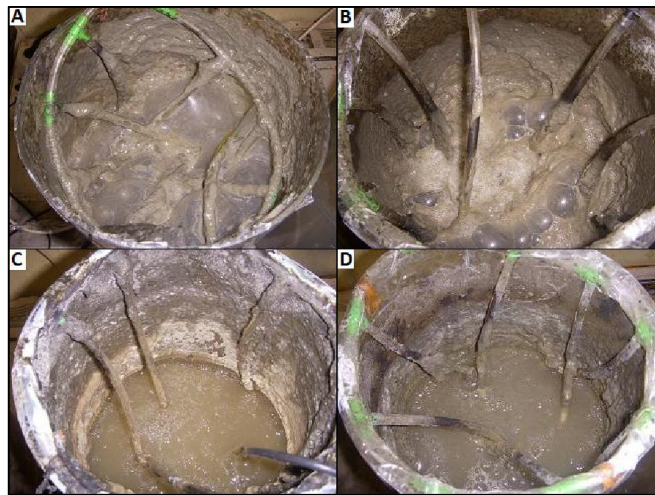
Figura 18. Espuma desarrollada en tanques a escala de laboratorio al inicio de la experiencia (día 2). (A) Reactor 1, (B) Reactor 2, (C) Reactor 3, (D) Reactor 4.
