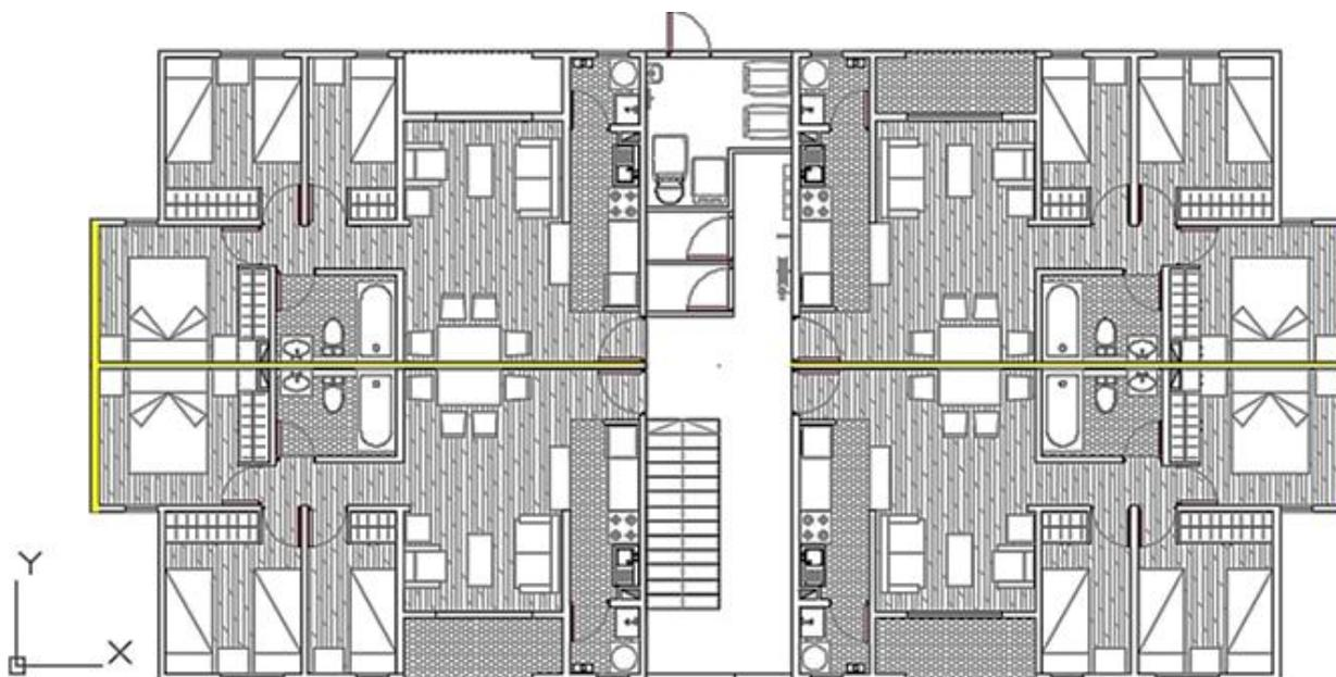
**Figura 6. Esquema de arquitectura en planta para edificio de 5 pisos con muros reforzados.**
