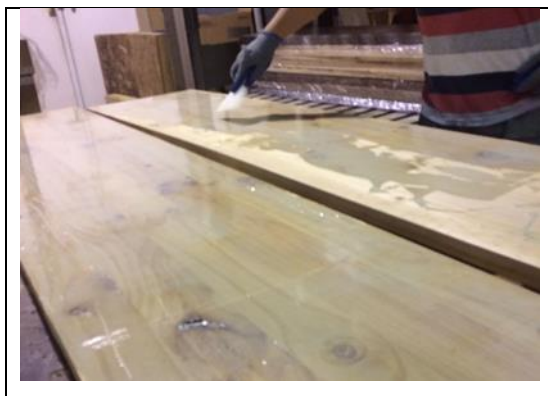
Figura D3. Pegado de paneles contralaminados.
