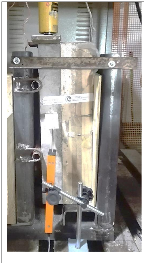
Figura 11. Ejecución de ensayos a corte
