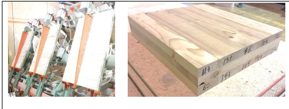
Figura 8. Proceso de fabricación de probetas CLT.
