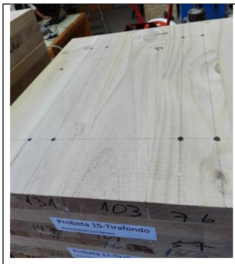
Figura D5. Diseño de inserción de conectores.
