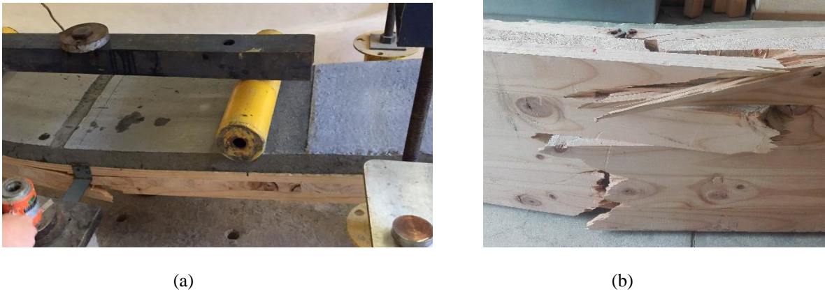
Figura 19. Tipo de falla observada ensayo a flexión.
