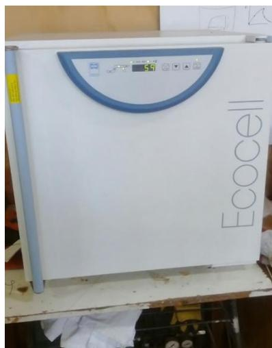
Fotografía B.2: Horno para el secado de muestras a 60°C
