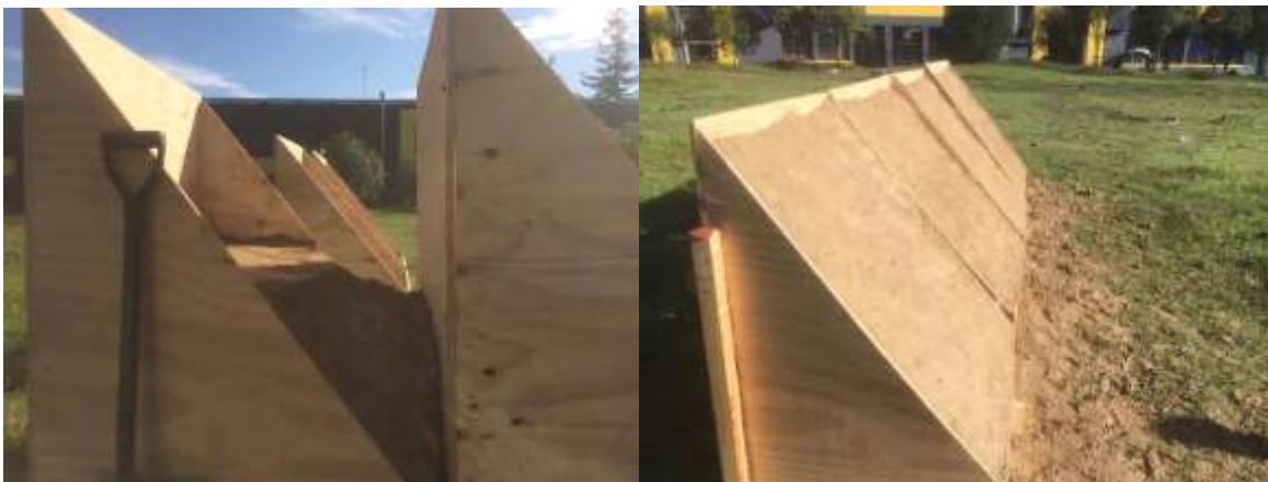
Figura 8. Compactación y llenado de lisímetros (Fuente: Elaboración propia)
