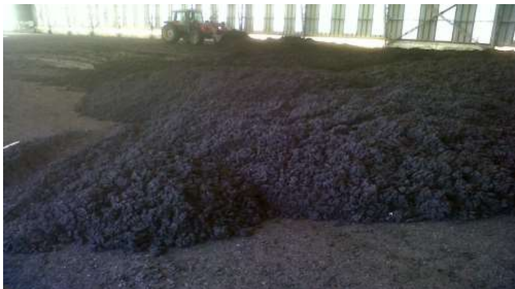
Figura 5. Lodos depositados en canchas de acopio. Planta de tratamiento ESSBIO Hualpén, Concepción. Chile (Fuente: López, A. 2012)
