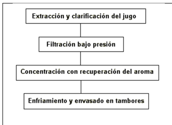
FIGURA 21: DIAGRAMA FLUJO DEL PROCESO DE ELABORACIÓN DE JUGOS CONCENTRADOS DE BERRIES
