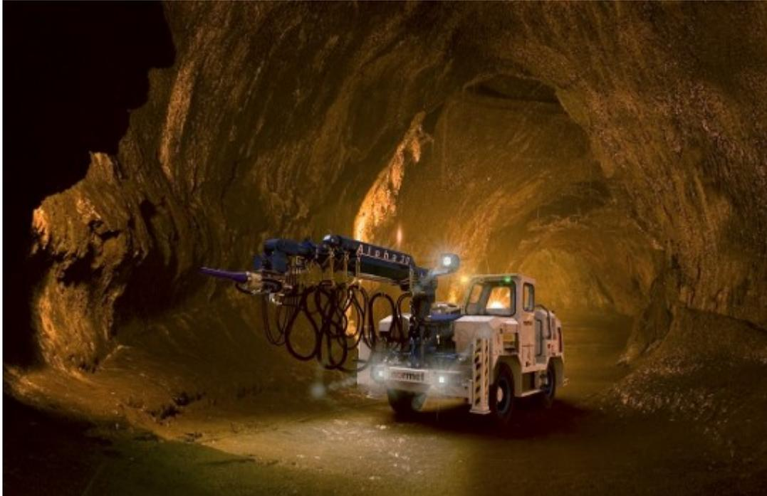
Las labores subterráneas pueden ser horizontales, verticales, inclinadas, conformando túneles, galerías, rampas, piques o chimeneas, ubicándose en los diferentes niveles que permiten fragmentar, cargar y transportar el mineral desde el interior de la mina hasta la planta, generalmente situada en la superficie.
