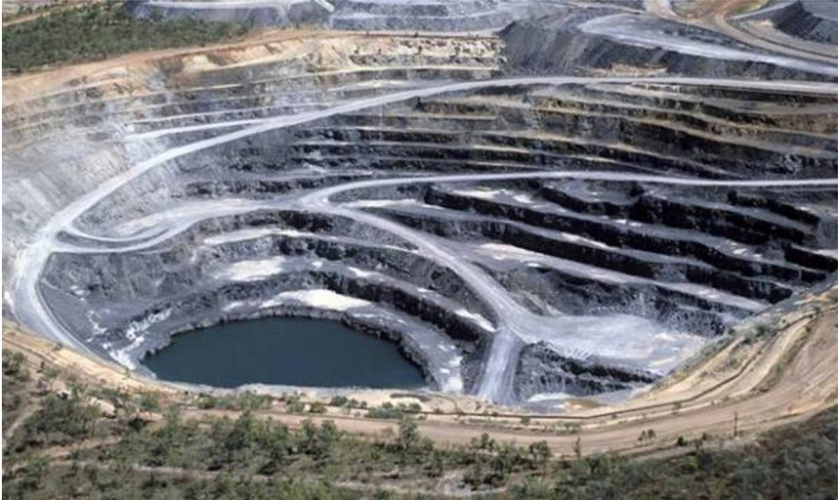
En la extracción a rajo abierto primero se remueve el mineral desde el yacimiento usando explosivos. La detonación se llama tronadura. Luego entran en operación los cargadores frontales o las palas eléctricas, capaces de levantar de una sola vez más de cien toneladas. Su labor consiste en cargar los camiones con el material fragmentado por la tronadura. Estos camiones llevan el mineral al chancador primario y el estéril, a los botaderos.
