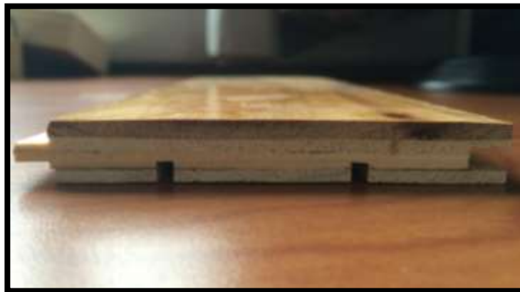
Figura 2: Perfilado del piso de ingeniería con sustrato contrachapado.
