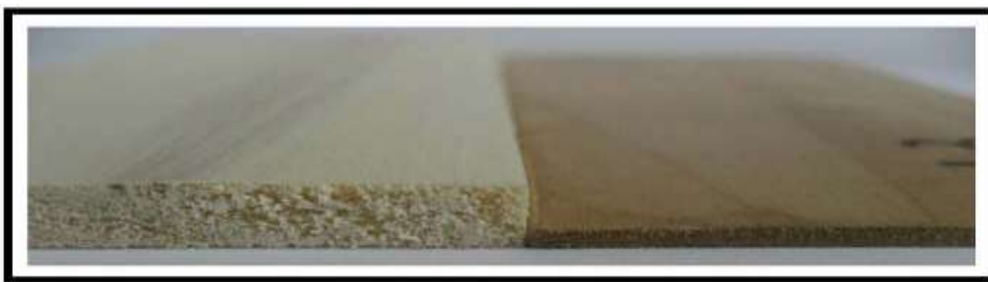
Figura 1: Diferencia entre madera sin densificar y madera densificada con el método de THM con una compresión de 130% (Rautkari et al. 2011).
