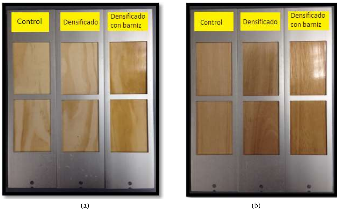
Figura 4: Porta muestra con probetas ordenadas respectivamente en condiciones control, densificadas y densificada con barniz: (a) Probetas Pinus radiata ; (b) Probetas de Eucalyptus nitens .
