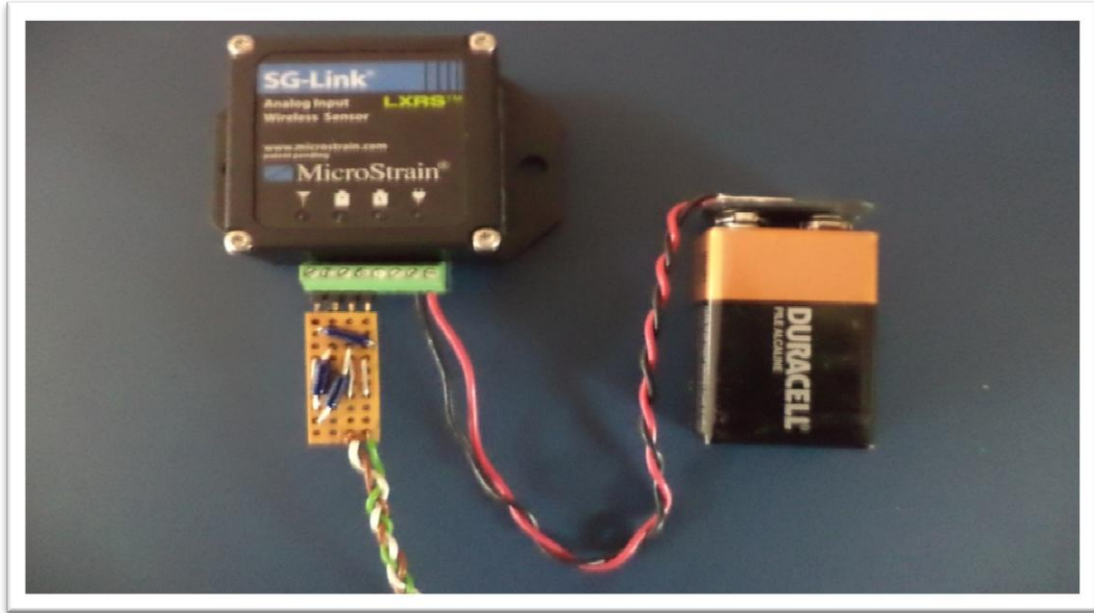
Figura 8.2.4b. Nodo con puente de Wheatstone y la celda de carga.
