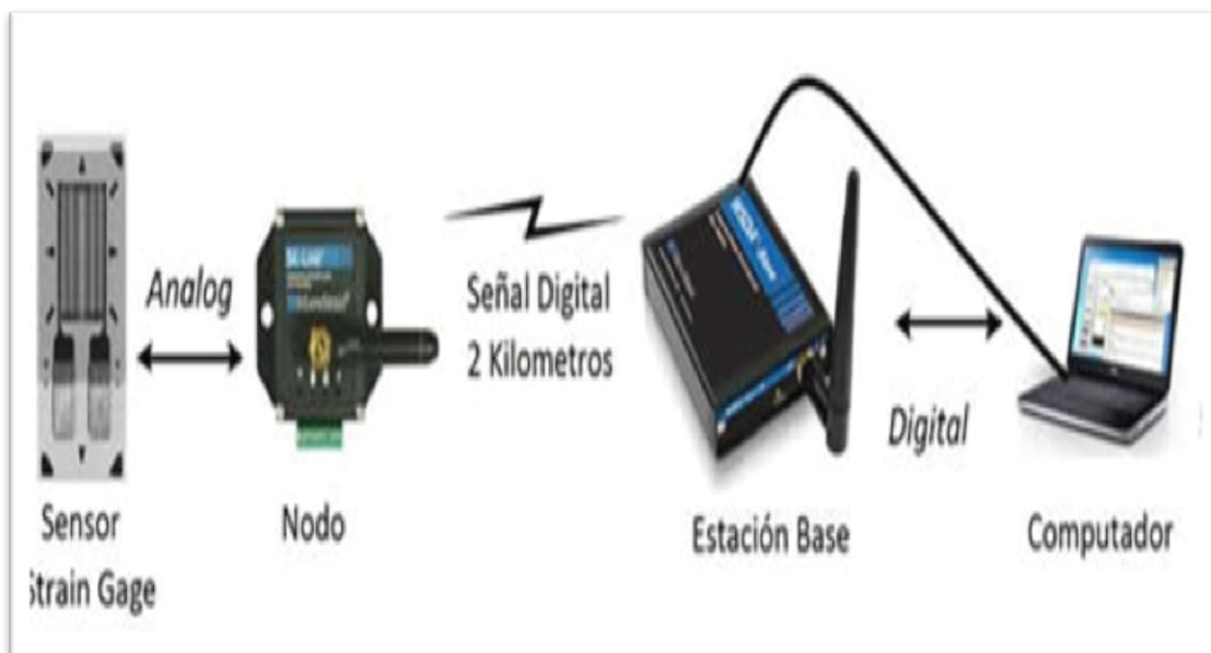
Figura 8.3c. Conexión de los dispositivos adecuados
