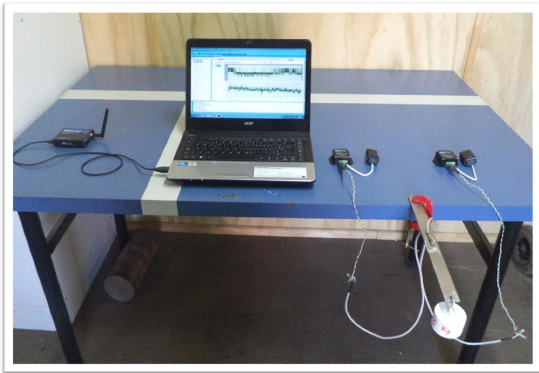
Figura 11.3a. Barra instrumentada con nodos micro strain.
