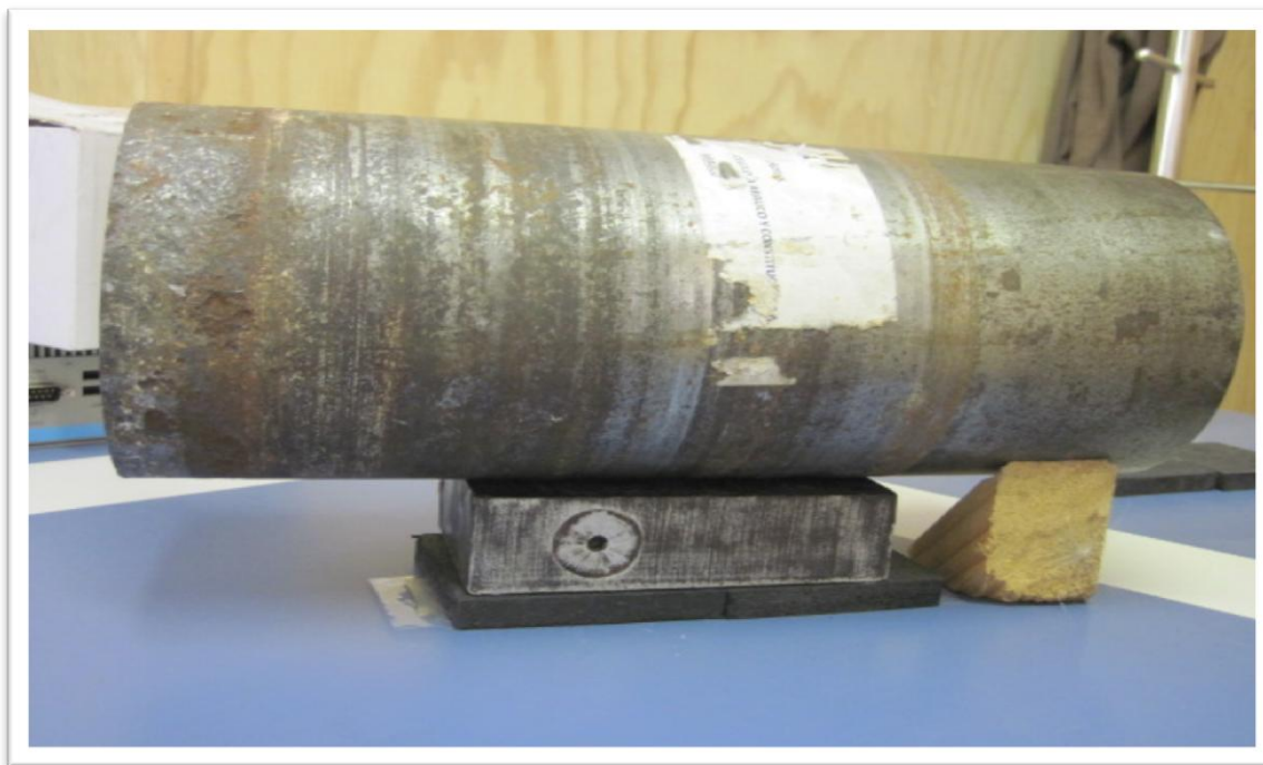
Figura 7.2.3d. Cubierta final para ejercer la presión necesaria en los Strain Gages.
