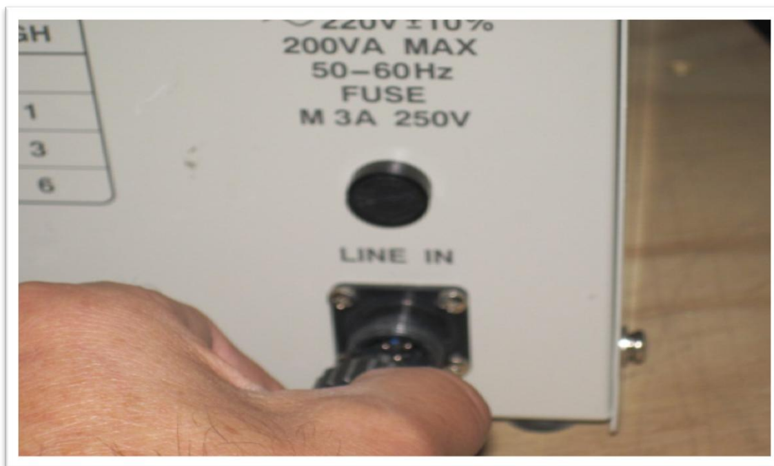
Figura 7.2.4b. Conector de entrada 220 Volts, 50 Hz.
