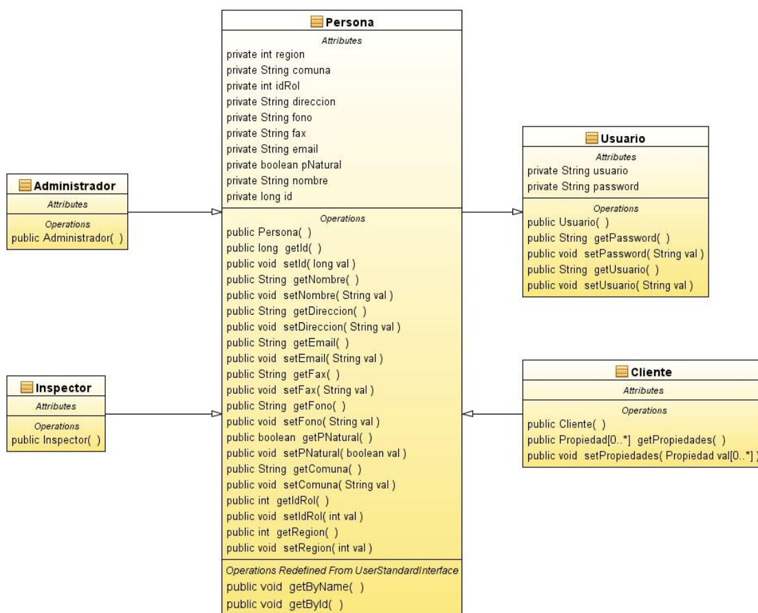
Figura 4.21: sección correspondiente a usuarios del diagrama de clases principal.
