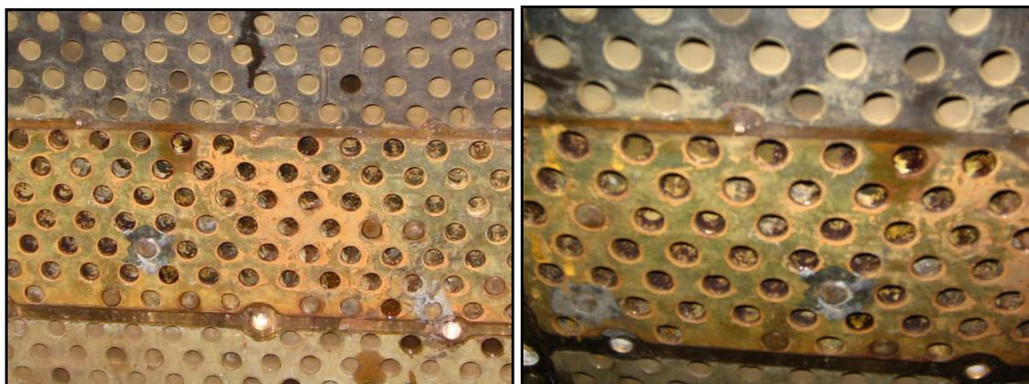
**Figura 2.11** Has de tubos con cavitación.
