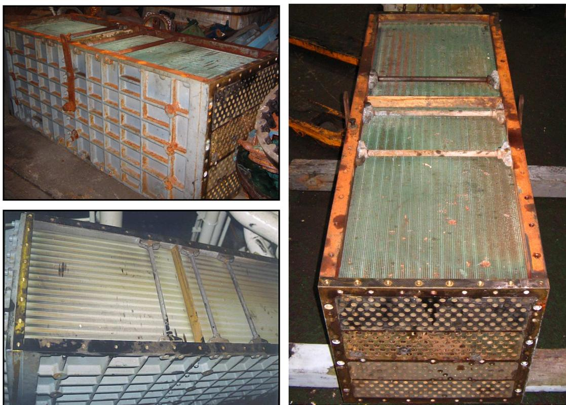
**Figura 2.8** Intercambiador de calor con superficie extendida o compacta.
