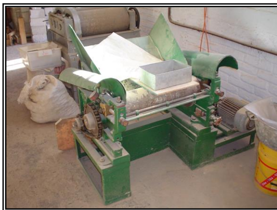
Foto N°3: Equipo averiado destinado para molienda primaria.
