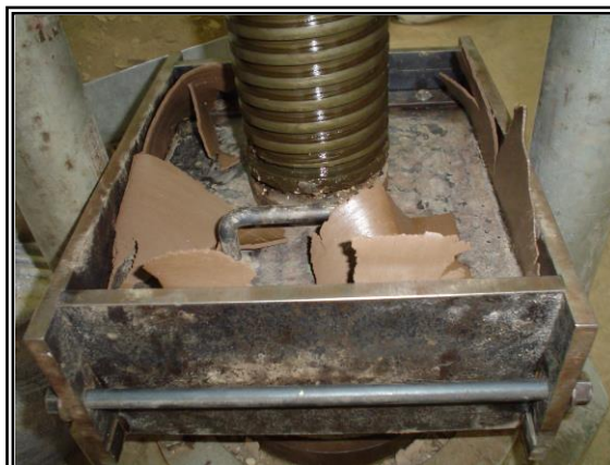
Foto N°21: Molde sometido a presión en la prensa
