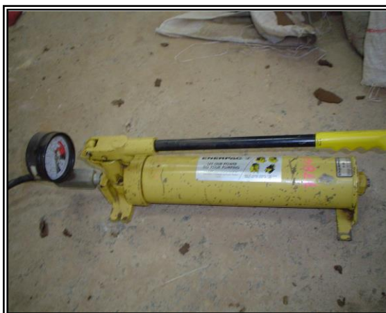
Foto N°22: Gata hidráulica. Capacidad máxima de presión 10.000 PSI
