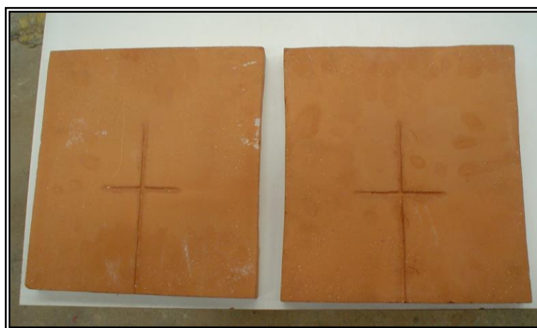
Foto N°30: Placas con cortes en cruz listas para incorporar a cámara de climatización.
