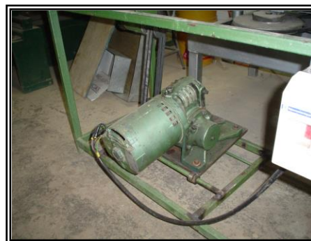
Foto N°10: Motor de \frac{1}{2} HP
