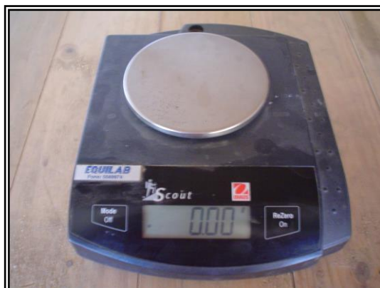
Foto N°8: Balanza digital de una precisión de 0.01 (mg) y una capacidad de 1.5 (Kg)
