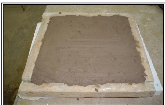
Foto N°16: Pasta en etapa de premoldeado, antes de retirar molde de madera.
