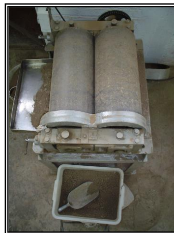
Foto Nº4: Rodillos por los que pasa el material para ser molida.
