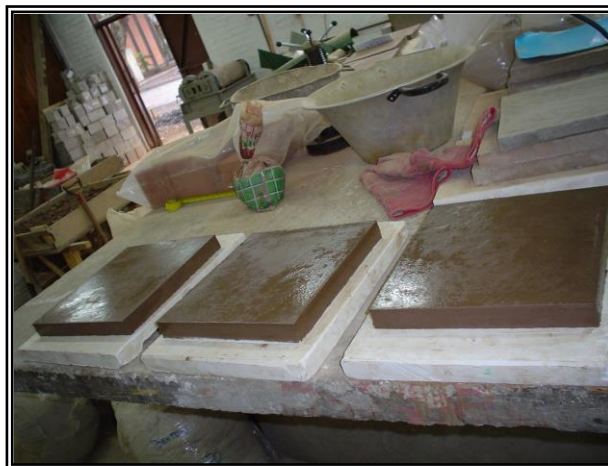
Foto N°23: Placas terminadas listas para ser pesadas y medidas.
