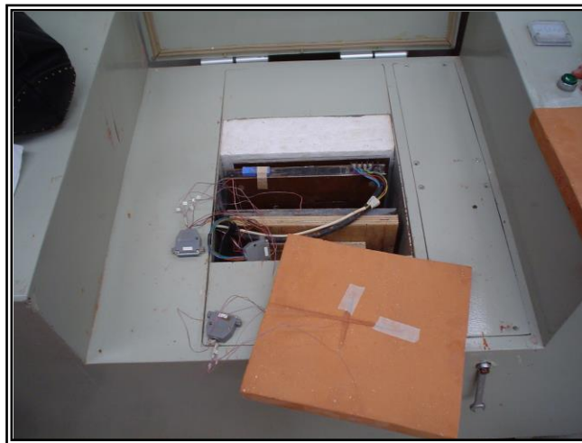
Foto N°33: Colocación de Termopares a las placas.
