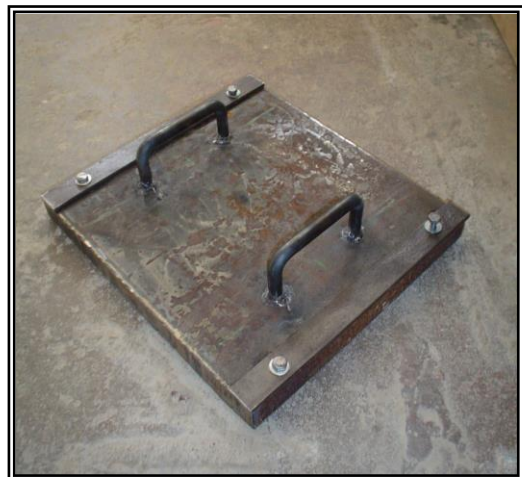
Foto N°19: Tapa de molde metálico de 2.5 cm. de espesor
