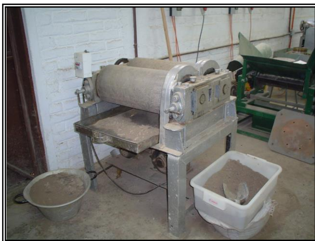
Foto Nº4: Rodillos por los que pasa el material para ser molida.
