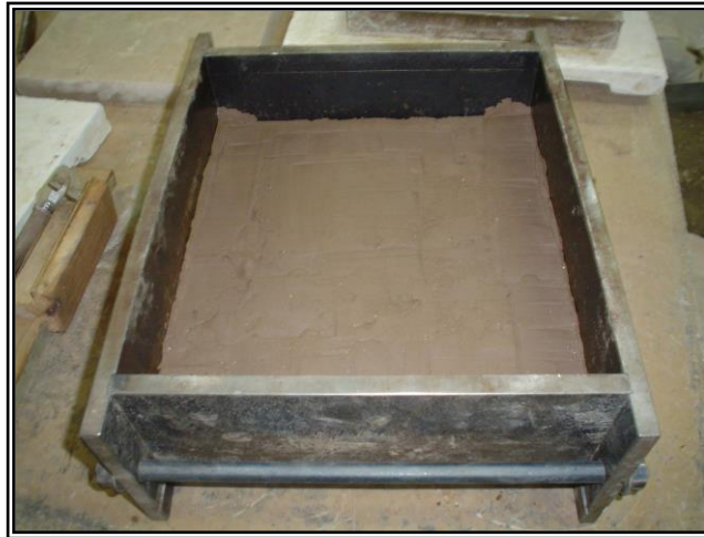
Foto N°18: Incorporación de pasta a molde metálico
