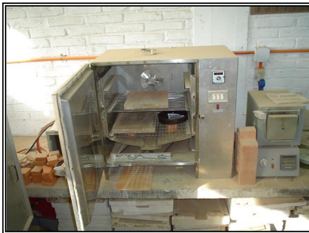
Foto N°25: Placas al interior del horno de secado
