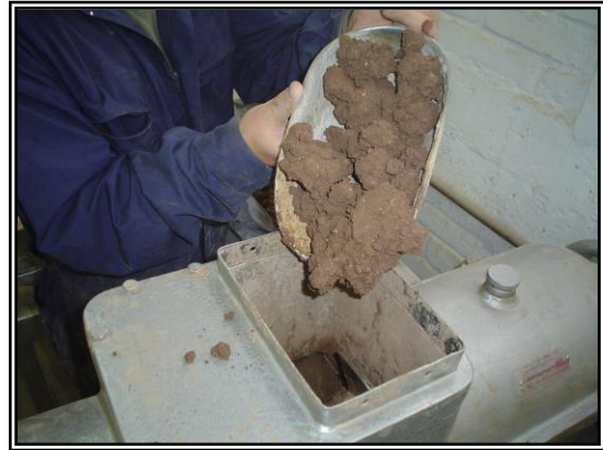
Foto N°13: Incorporación de la pasta a la extrusora
