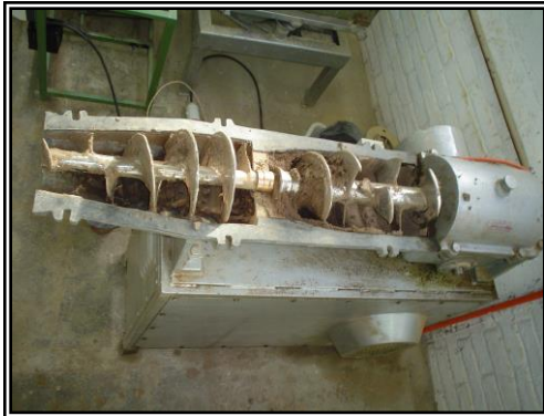
Foto N°12: Interior de máquina extrusora.
