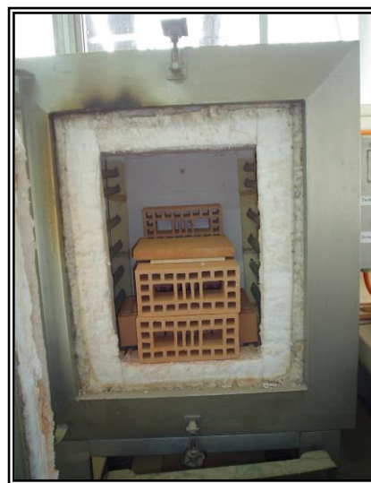
Foto N°26: Equipo en el que se calcinan las
