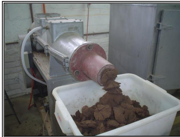
Foto N°14: Pasta saliendo de la extrusora.
