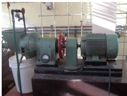
Imagen 20: Desfibrador Bauer, modelo 148-2 / Fuente: Propia
