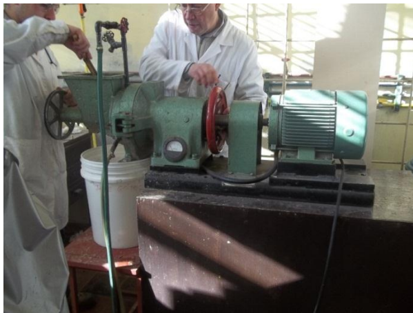
Imagen 19: Desfibrador Bauer, modelo 148-2 / Fuente: Propia
