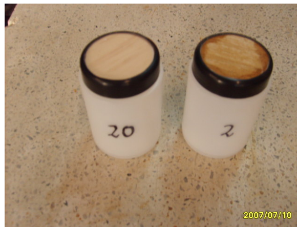
Figura Nº 5: Copas de permeabilidad con probetas revestidas.
