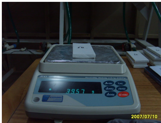
Figura Nº 4: balanza utilizada para medir Masas en experiencias de flotación y lixiviación.
