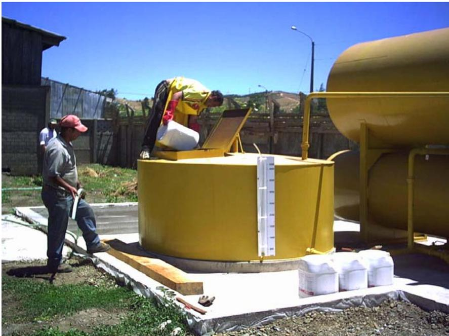
Figura 16, Carga de preservante al estanque de mezcla.
