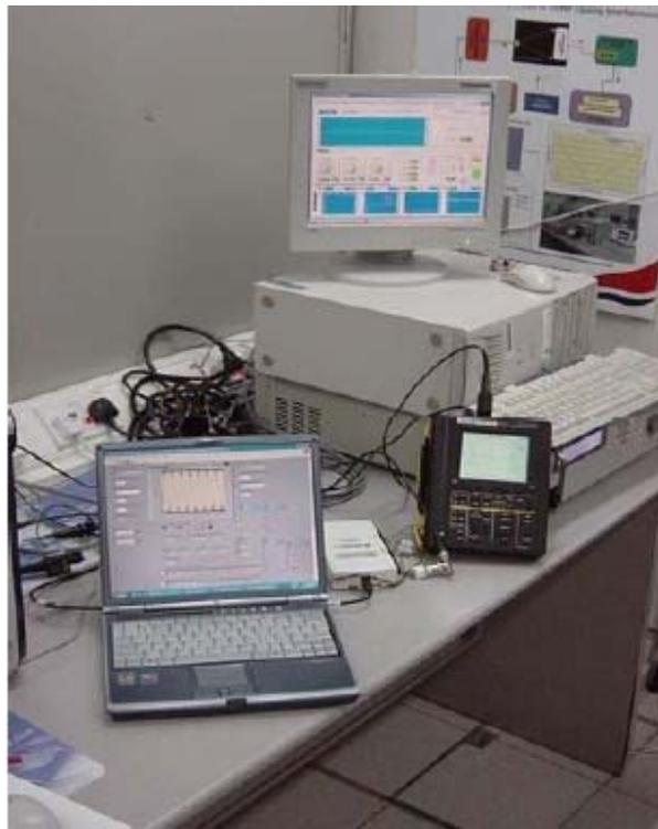
*Figura 4.31. Componentes físicos del sistema propuesto de medida del parpadeo.*
