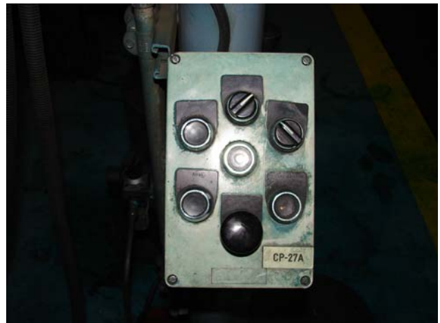
Fig. N°13: CP 27A, control de transportador 820 y marcador de fardos.
