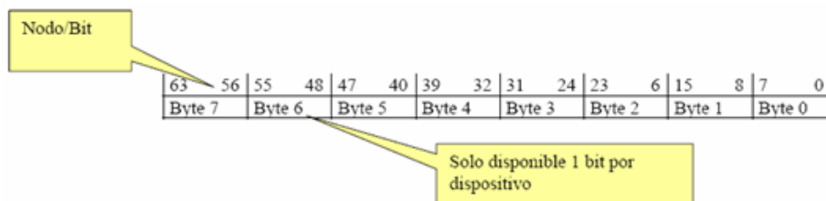
Fig. N°25: Formato de transmisión Strobe
