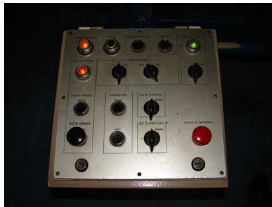
Fig. N°15: CP 25, control cadena transportador 822 y plegadora
