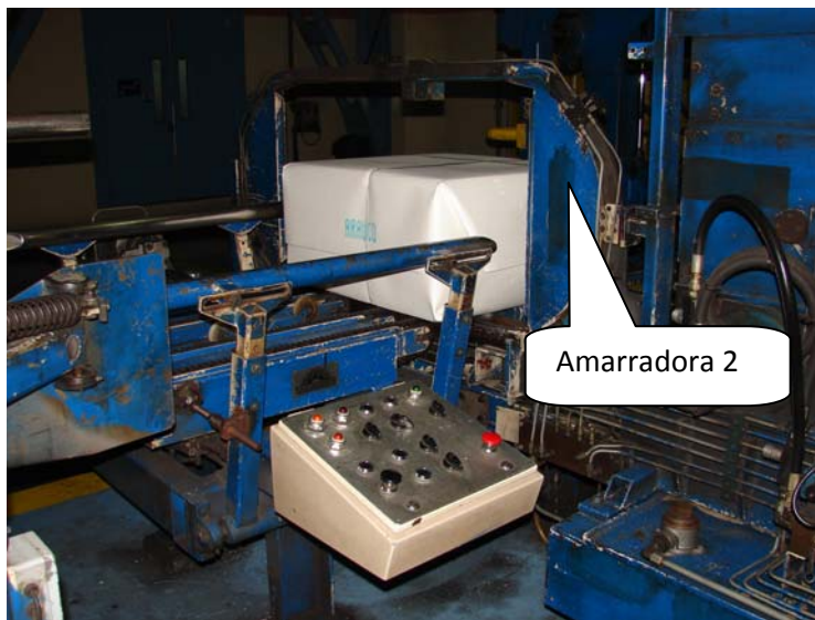
Fig. N°16: CP 26, control cadena transportador 823 y amarradora #2.
