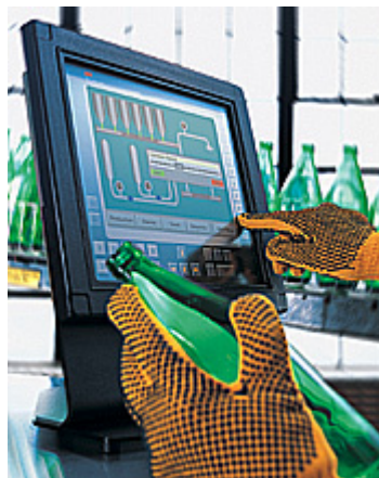
Fig. N°70: Pantalla táctil resistiva
