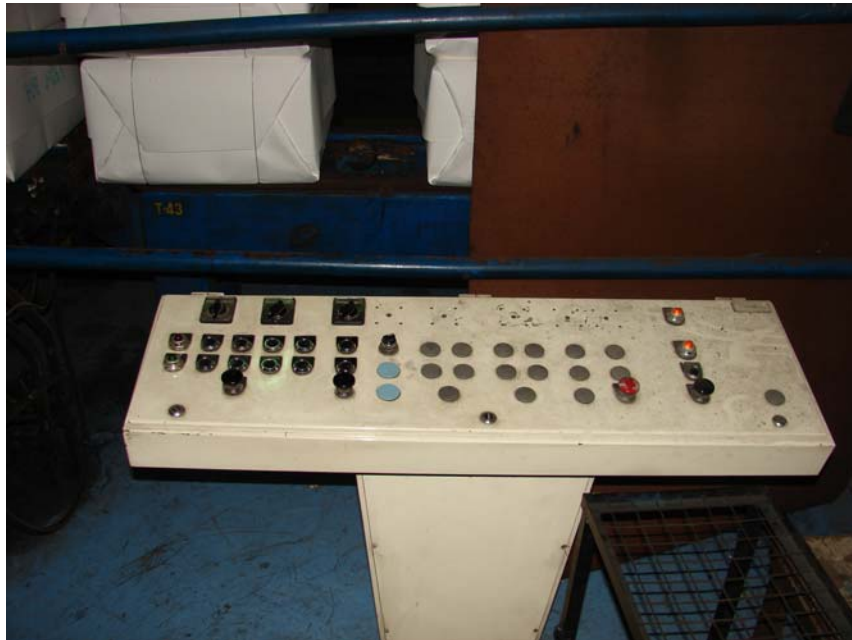
Fig. N° 18: CP 27, control de transportador 936, transportador 824, horquilla y ajustadores.
