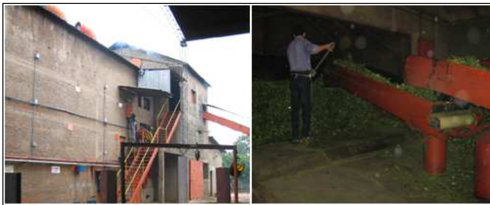
Figura N°3.5: Secadero de cintas e ingreso de la yerba al secadero de cintas desde la “palomera”.
