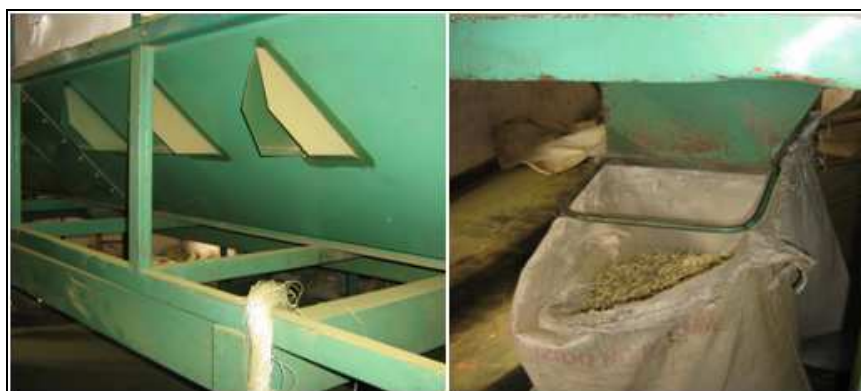
Figura N°3.7: Zaranda y salida de palos desde la zaranda. Fuente: Archivos Propios.
