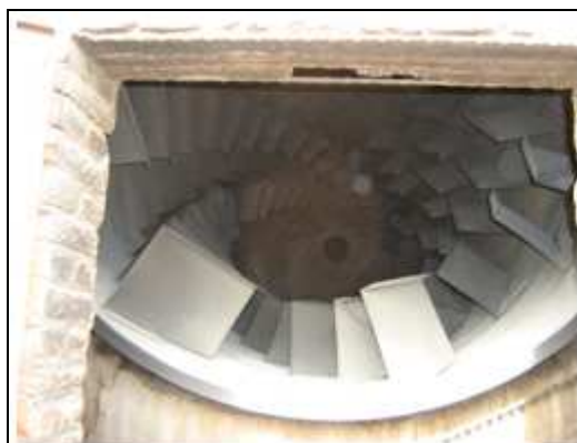
Figura N°3.4: Estructura interna de aspas de las tamboras de zapecado y presecado. Fuente: Archivos Propios.
