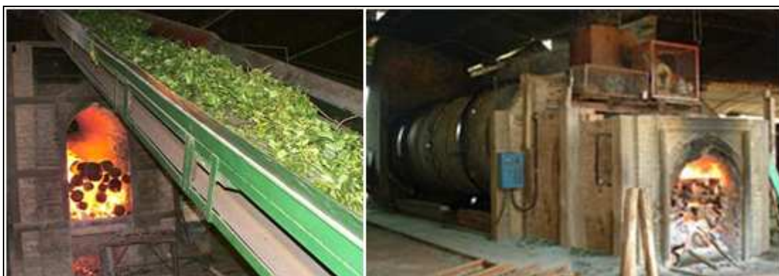
Figura N°3.3: Ingreso mediante cintas transportado ras hasta la tambora de zapecado; Tambora de zapecado
