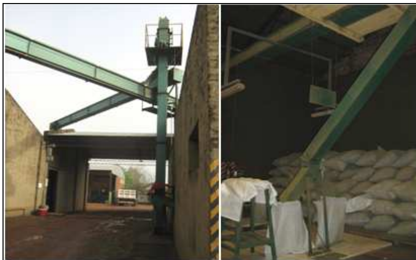
Figura 3.9: Transporte elevador de la yerba zarandeada hacia depósitos. Embolsado de la yerba. Fuente: Archivos Propios.
