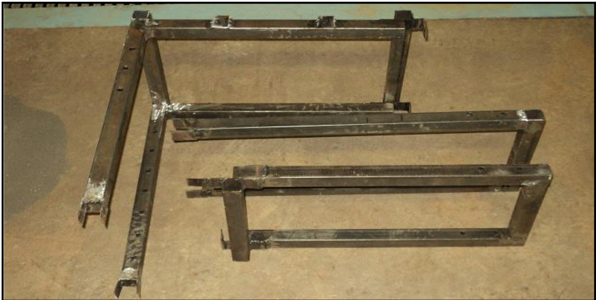
Figura J9: Montaje de plataforma metálica utilizada para soportar equipo de sondaje.
