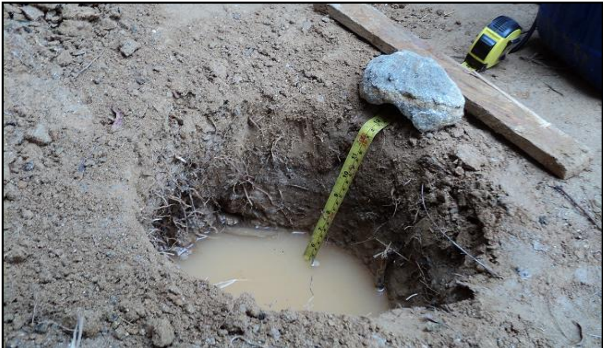
Figura J4: Realización de ensayo para obtener el coeficiente de infiltración del suelo mediante el método PORCHET.
