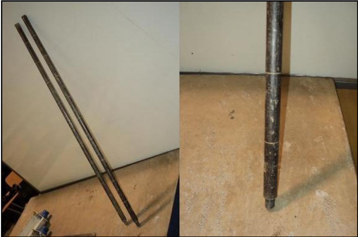
Figura D5: Detalle de varillas de traspaso de carga de equipo de sondaje DPL
