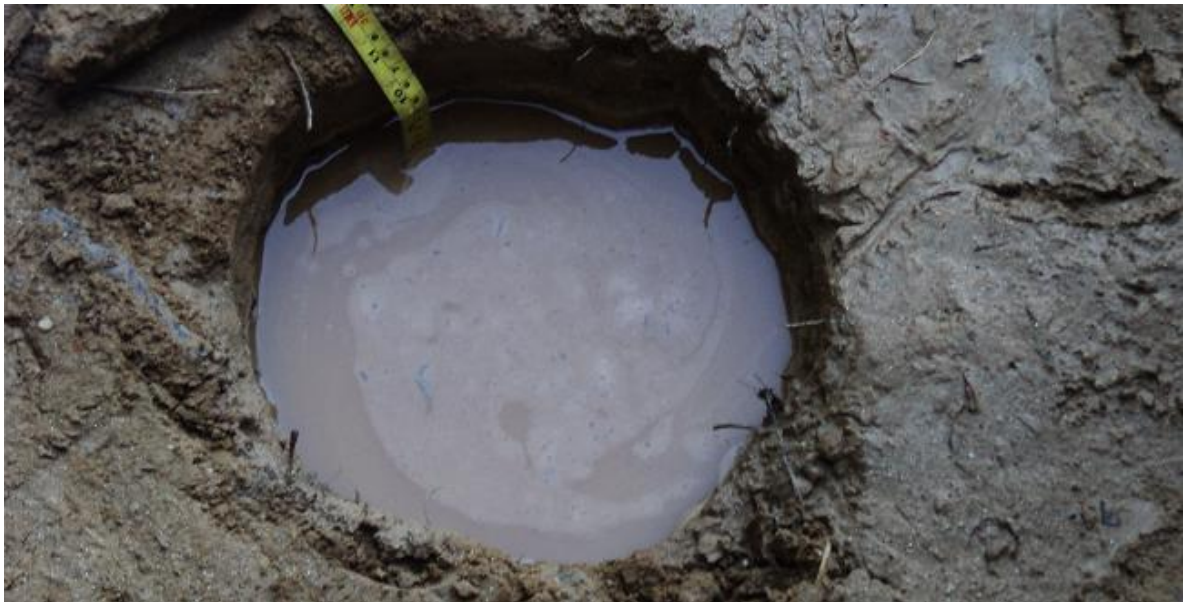
Figura J13: Realización de ensayo PORCHET para obtener coeficiente de infiltración al término del estudio.
