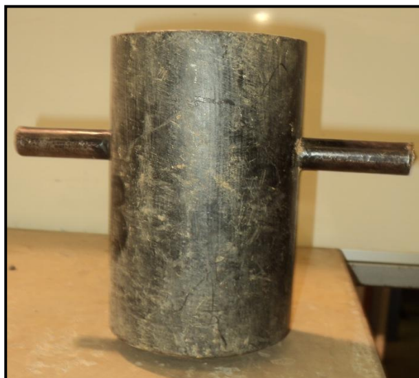
Figura D3: Detalle de martillo de golpe de equipo de sondaje DPL
