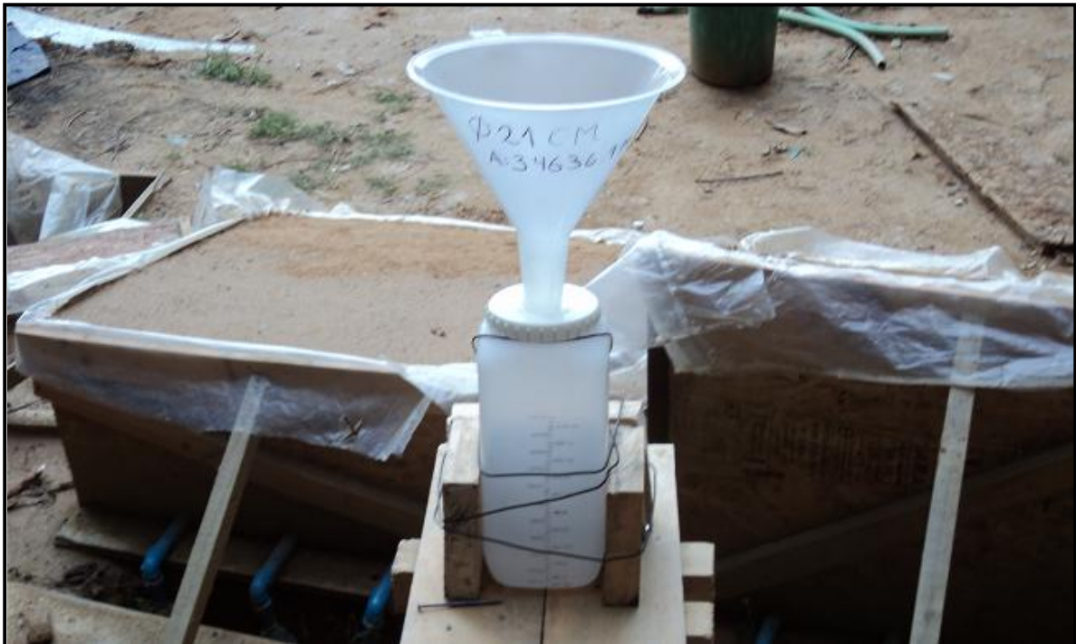
Figura J5: Ubicación de pluviómetro en la zona de trabajo.
