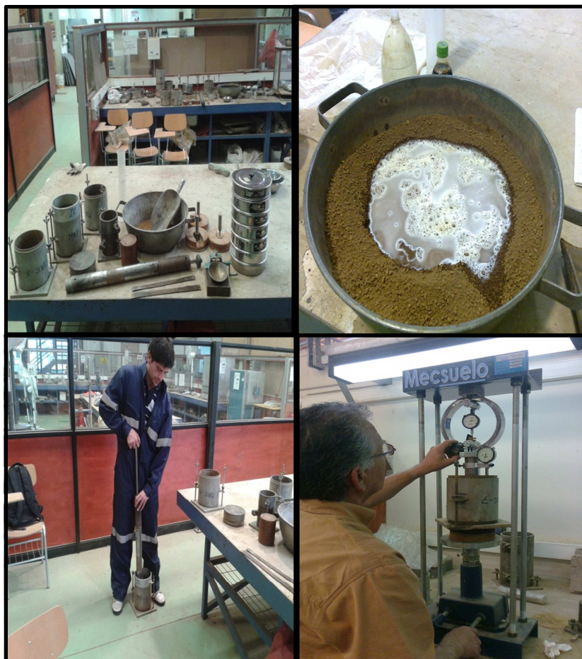
Figura 6: Materiales, Materias primas, compactación y penetración moldes CBR.
