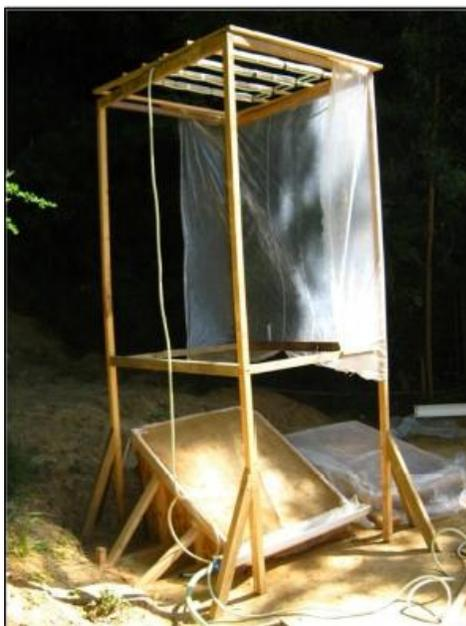
**Figura 2:** Sistema completo de lluvia artificial.
