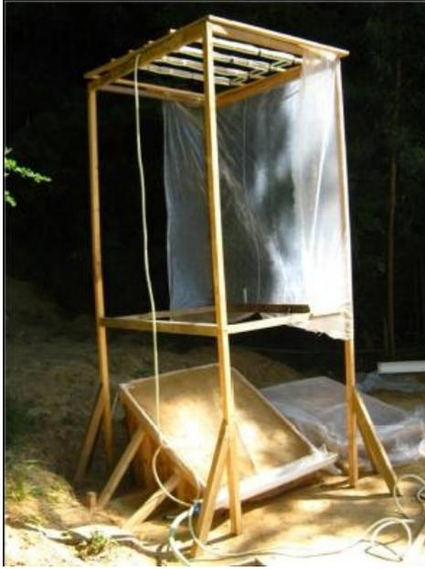
Figura 4: Simulador de lluvia artificial.
