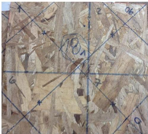
**Figura 11. Probeta de tableros OSB**
