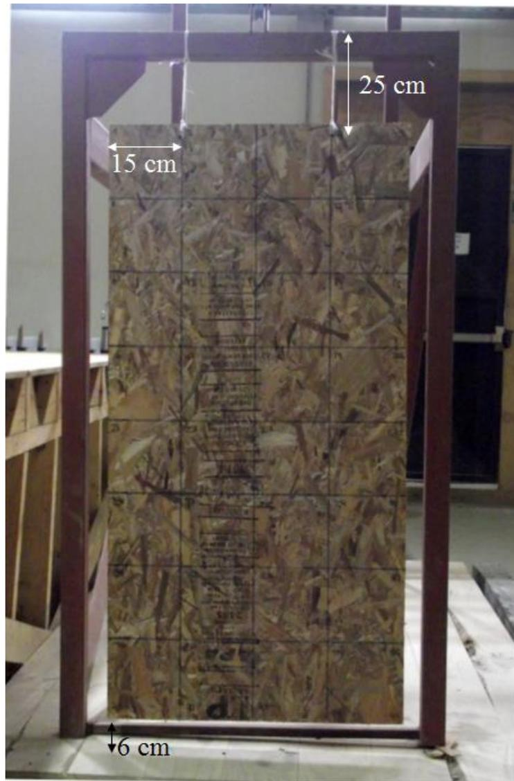
**Figura 6. Esquema de distancias en conexiones.**
