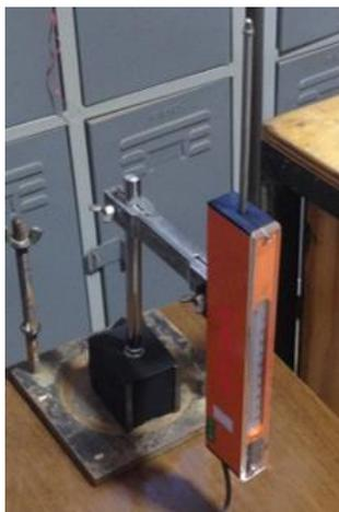
**Figura 12. Transductor de desplazamiento utilizado**
