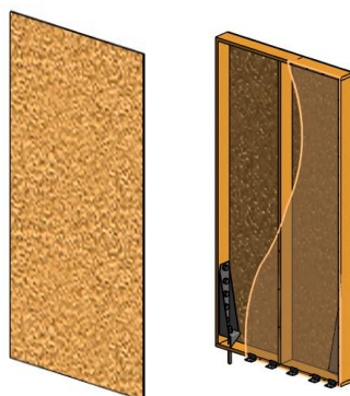
Figura 12. Modelo 3D de placa OSB y orientación en muro de corte
