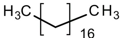
Figura N°3.2. Forma estructural del octadecano
