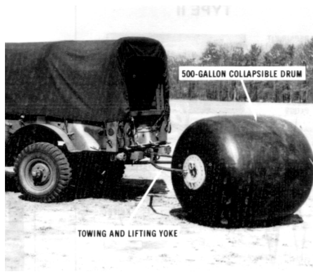
Figura 6.7 Transporte de tambores plegables mediante arrastre
