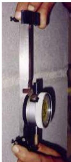
Figura 3.7 Lectura de las deformaciones en los prismas con extensómetros mecánicos
