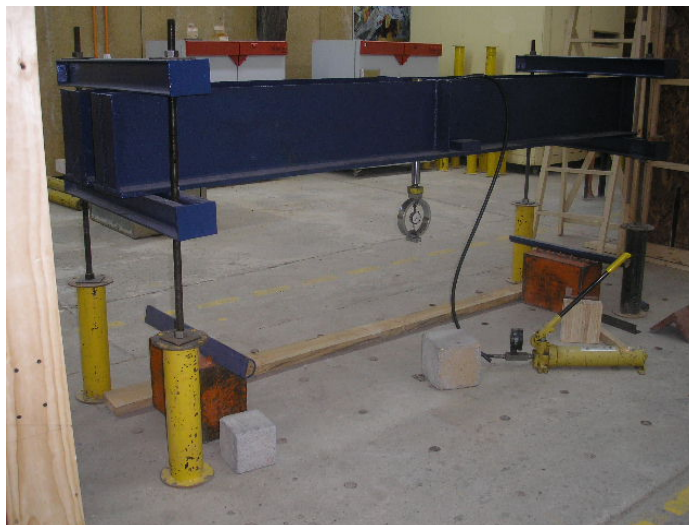
Figura C- 1: Marco de carga de 4 ton
