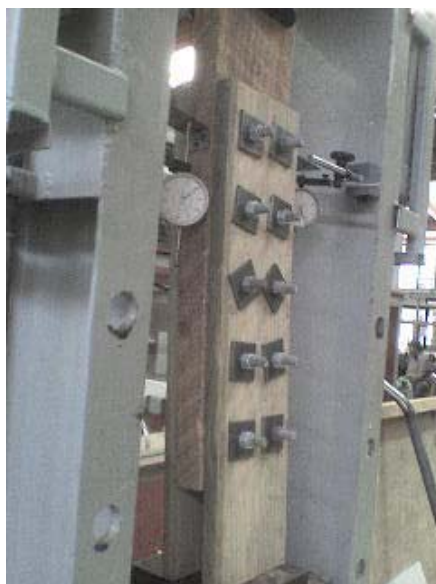
Figura 4- 10: Pandeo Probetas 5 Pernos por Hilera
