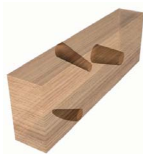
Figura 1- 11: Proyección del nudo en la sección interior de la pieza
