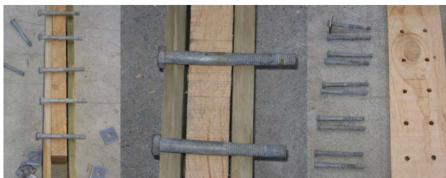
Figura 4- 12: Modo de Falla III, Probetas de 5 pernos de 5/8” por hilera.
