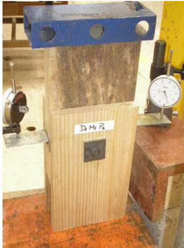
Figura C- 8: Deformómetros sobre placas rígidas.
