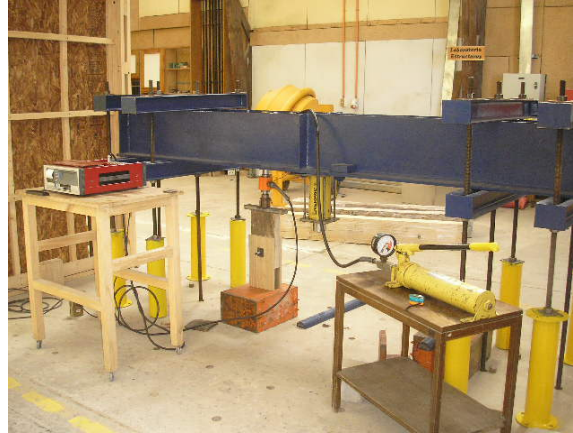
Figura C- 6: Conjunto Marco de carga, bomba, cilindro y Data Logger.
