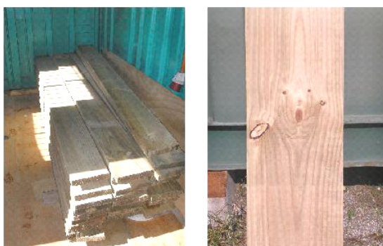
Figura 3-2: Piezas de madera estructural, tipo G1
