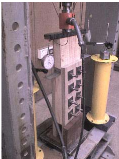
Figura 4- 9: Pandeo Probetas en sector libre de medios de unión.
