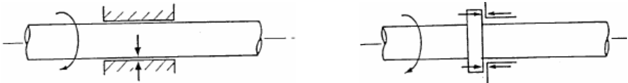
Figura N°2: Fuerzas en cojinetes radiales y axiales.
