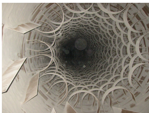
Figura 4: Salida del secador Haas. Aquí se muestran las dos clases de levantadores presentes en este equipo.
