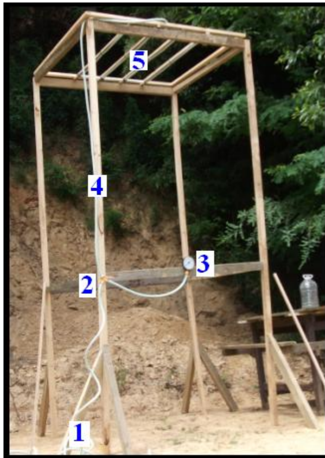
Figura 23: Simulador de lluvia. 1) Manguera de alimentación; 2) Bifurcación; 3) Manómetro; 4) Estructura soportante; 5) Sistema de aspersión (Fuente: Elaboración propia).
