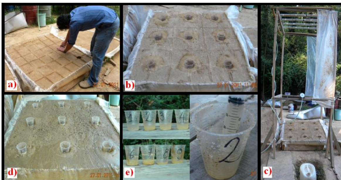
Figura 46: Calibración: a) Trazado de grilla y excavación para apoyo de vasos, b) Colocación de vasos de acuerdo serie 1-2-3 (superior), 4-5-6 (medio) y 7-8-9 (inferior), c) Aplicación de la lluvia, d) Recolección del volumen precipitado, e) Medición del volumen almacenado. (Fuente: Elaboración propia).
