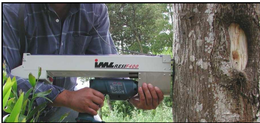
Figura 4. Uso del resistógrafo in-situ ( www.arvores-e-pessoas.pt )
