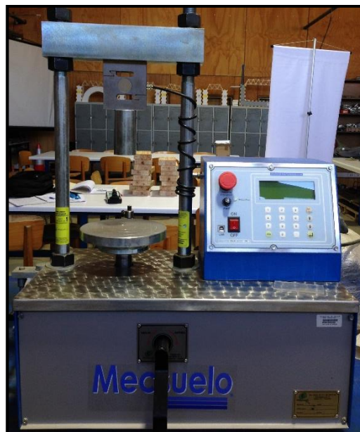
Figura 9. Prensa multiusos semiautomática modelo PS-25M
