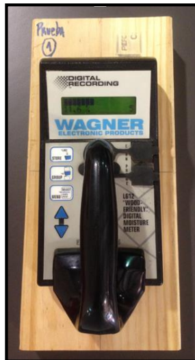
Figura 17. Determinación contenido de humedad mediante xilohigrómetro
