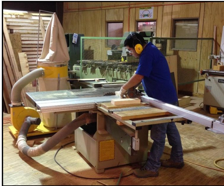
Figura 13. Confección de probetas mediante sierra industrial
