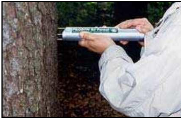
Figura 5. Ensayo penetrómetro en madera ( www.gisiberica.com )
