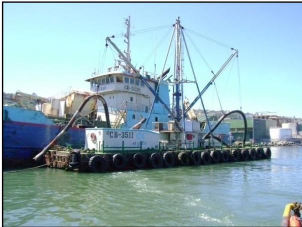
Pontón, (Sala de bombas) utilizado para la descarga de los PAM
