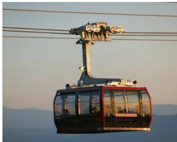
Figura n° 01: “Teleférico tricable” Fuente: Empresa Leitner ropeways.
