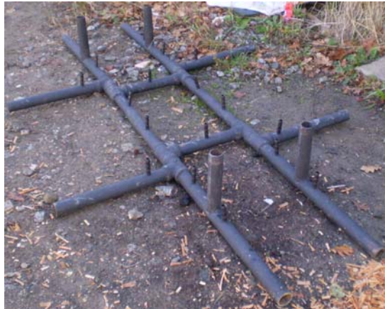
Fig. Nº 3.4: Sistema de aireación terminado con difusores de 10mm de diámetro incorporados.
