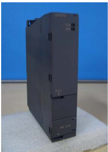
Figura 19. Fotografía modulo CPU del PLC Mitsubishi serie IQ
