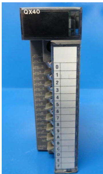
Figura 20. Fotografía modulo entradas digitales del PLC Mitsubishi serie IQ
