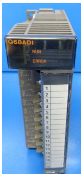
Figura 22. Fotografía módulo entradas análogas del PLC Mitsubishi serie IQ
