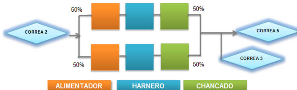
Figura 22 Diagrama lógico Harneado y Chancado Secundario
