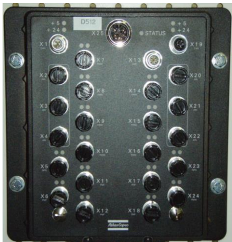
Figura 2.6: Módulo I/O, disposición de conexiones
