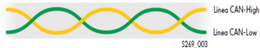
Figura 2.27: Diagrama de trenzado de Cables.
