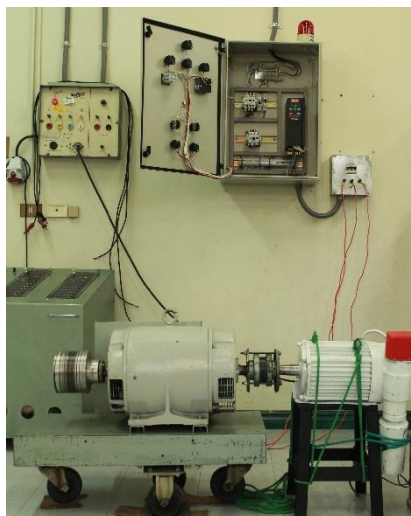
Figura 4.16: Generador eólico acoplado a un MIRB para pruebas.
