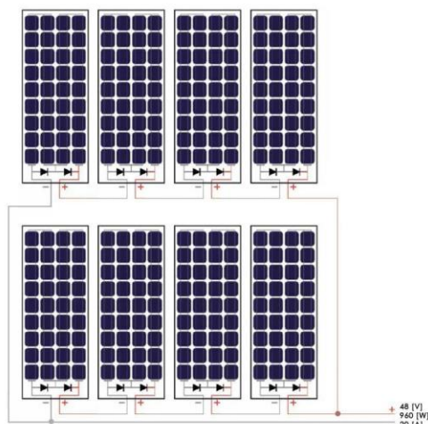
Figura 2.9 Paneles fotovoltaicos en conexión mixta.
