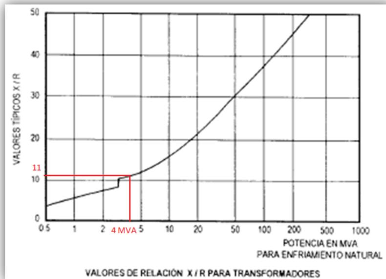
Figura B.6.- Gráfico relación X/R versus potencia nominal de transformador.
