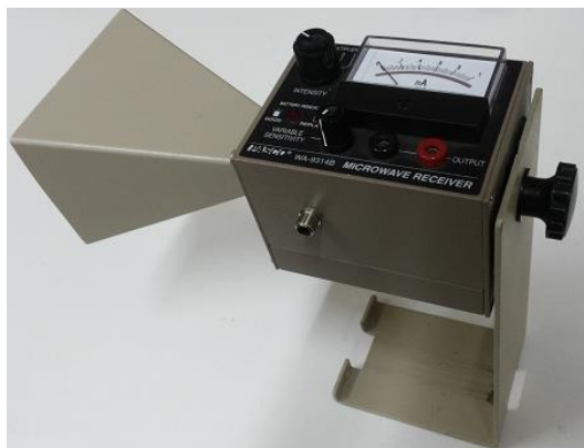
Figura N° 5.6: Receptor de microondas
