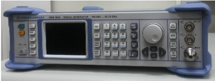
Figura N° 5.4: Generador de microondas
