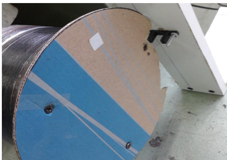
Figura 3.3 Disco obstructor y el sensor TCST1103.
