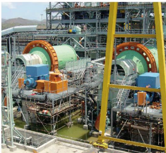
Aplicación: Molino de bolas 4.600 kW, 11.000 V, 6 polos, carcasa 800
