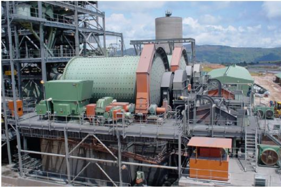
Aplicación: Molino de bolas 6.500 kW, 11.000 V, 6 polos, carcasa 900
