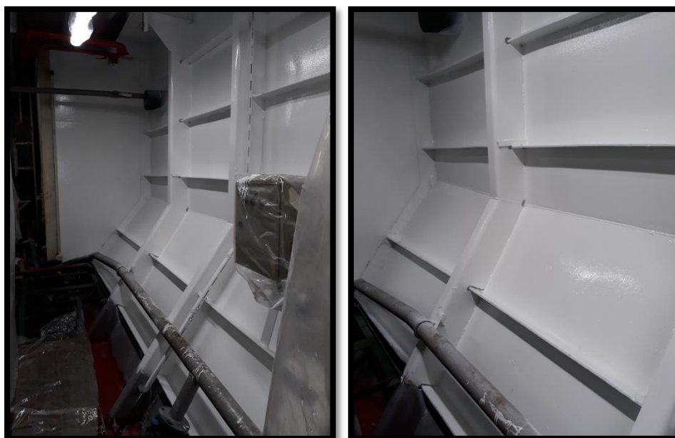
Imagen 6.1.e; Esquema de pintura en mamparos, Sala de generadores
