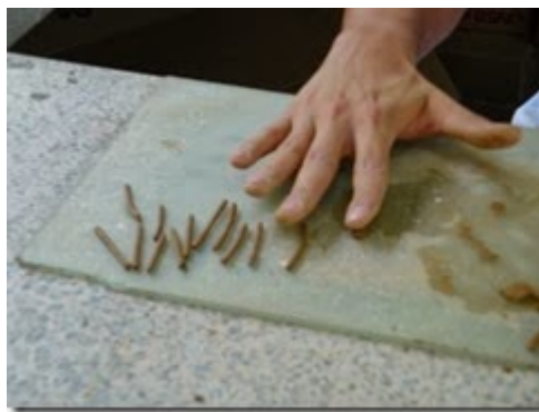
Figura N° 7: Determinación del límite plástico
