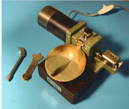
Figura N° 6: Instrumento para determinar el Límite Líquido según Casagrande
