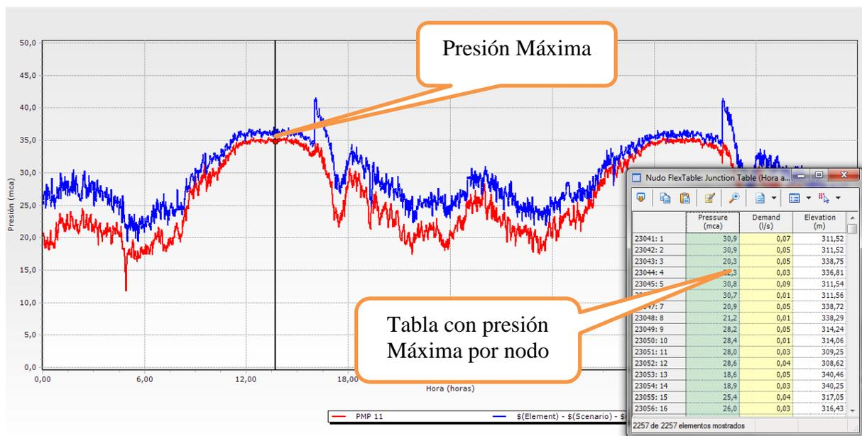
Figura D 12 Presión máxima en Modelo Hidráulico
