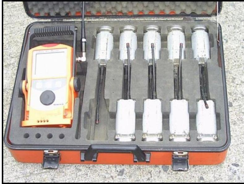
**Figura B 6 Equipos de detección y emisor de señales de radio logger**
