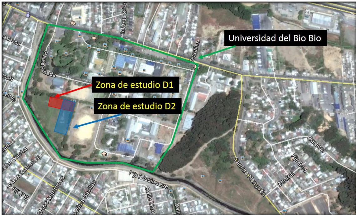
Figura C1.- Universidad del Bio Bio. Sitio de estudio: Cancha de rugby. Dirección de arreglo de geófonos D1 y D2.
