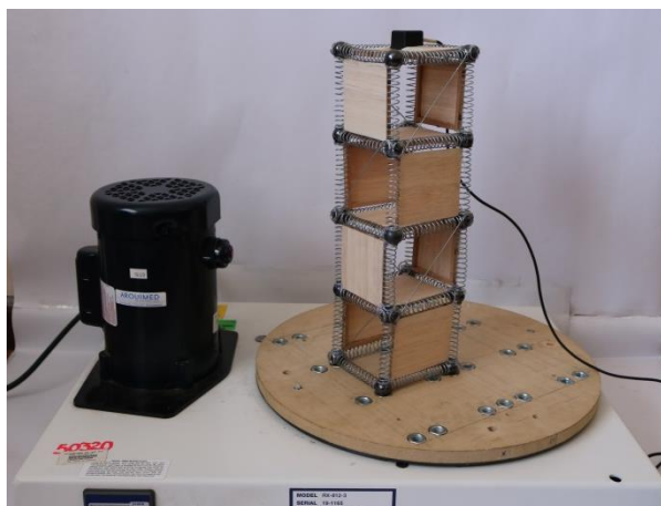
Figura E100. Estructuras con muros y diagonales.
