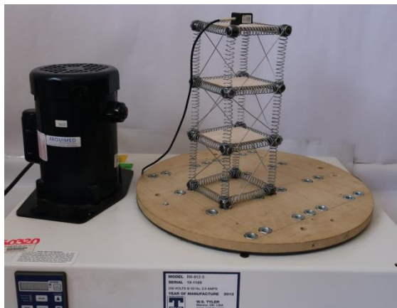
Figura E103. Estructura con frecuencia cercana a la de la mesa.
