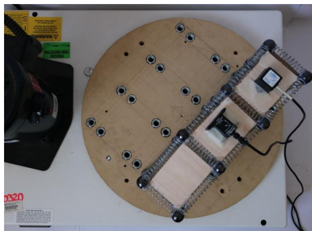
Figura E117. Estructura asimétrica, módulo central-módulo derecho.
