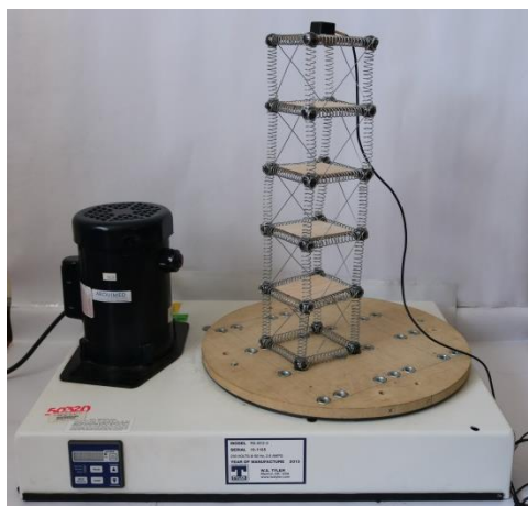
Figura E73. Estructura de 5 pisos.
