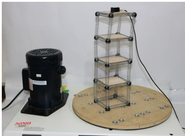
Figura E91. Estructura flexible.
