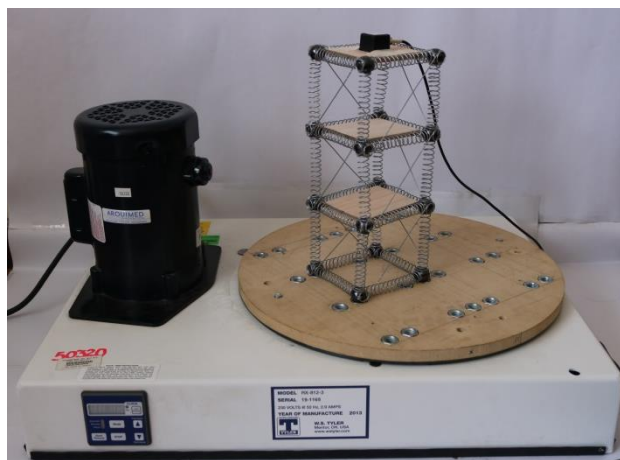
Figura E67. Estructura de 3 pisos.
